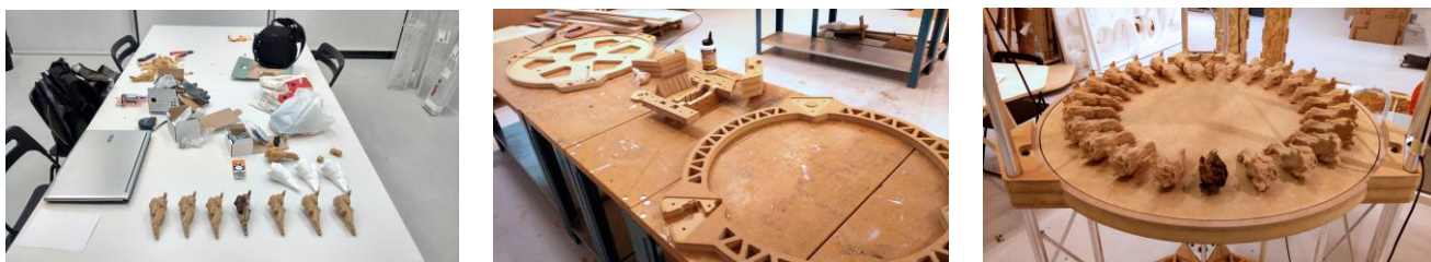
Figura 4. Proceso de fabricación y montaje de la estructura del zoótrolo, y posterior disposición de las impresiones 3D en el plato central para comenzar con las pruebas de sincronización de las luces con el giro del motor.
