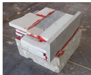
Figura 7. Aspecto inicial del bloque reconstruido
