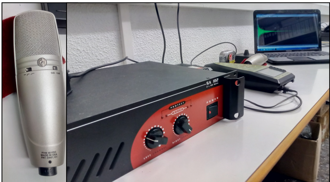
Figura 6: Equipos empleados: micrófono, amplificador y software “DIRAC”
