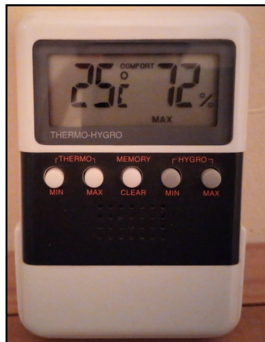
Figura 10: Thermo-Hygro temperaturas y humedades relativas
