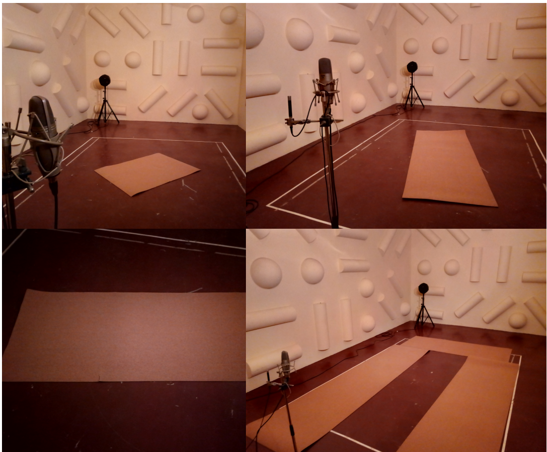
Figura 19: Laminado de partículas de corcho en cámara reverberante
