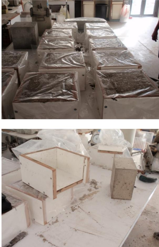
*Figura 5.16 Cubrición de las probetas con film plástico durante 2 días y desmoldado de probetas de hormigón*
