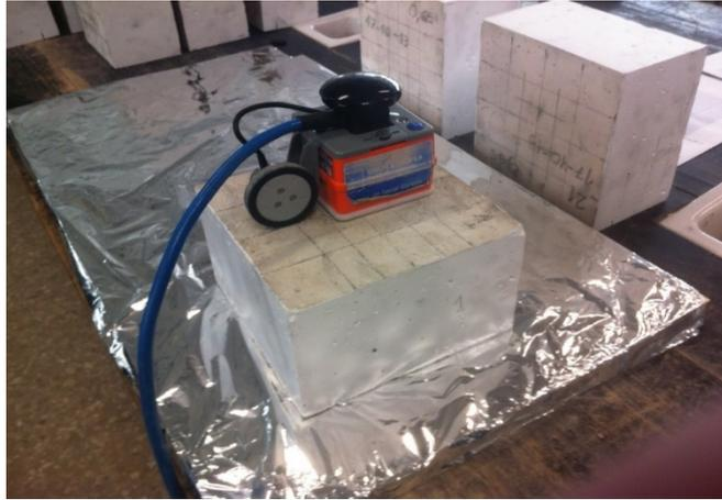
*Figura 5.20 Colocación de la probeta sobre papel de aluminio para la medición con georradar*
