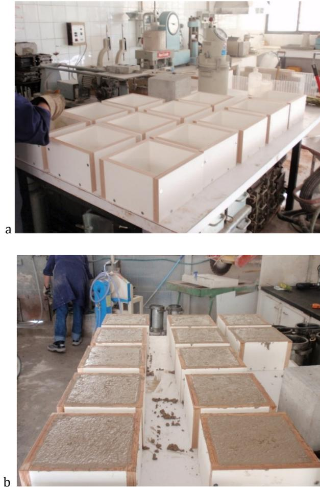
*Figura 5.15 (a) Moldes para la fabricación de las probetas y (b) curado del hormigón*
