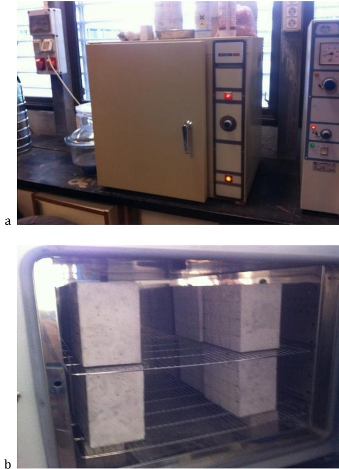
*Figura 5.18 (a) Horno de secado de las probetas y (b) tanda de secado de 8 probetas*
