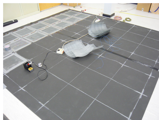
Imagen izquierda: Detalle de las superficies de Icolén. Imagen derecha: Detalle de los interruptores con malla metálica.
