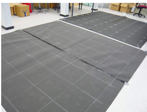
Imagen izquierda: Detalle de las superficies de Icolén. Imagen derecha: Detalle de los interruptores con malla metálica.
