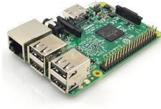
Figura 11 - Raspberry Pi. Recoge los datos enviados por LoPy como si fuesen de sensores
