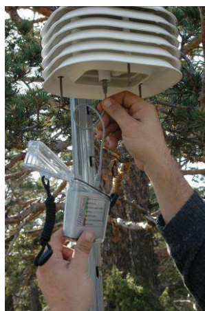
Fotografía 15 y 16: Registro de Temperaturas digital (Dataloger Hobo) y detalle de descarga de datos.
