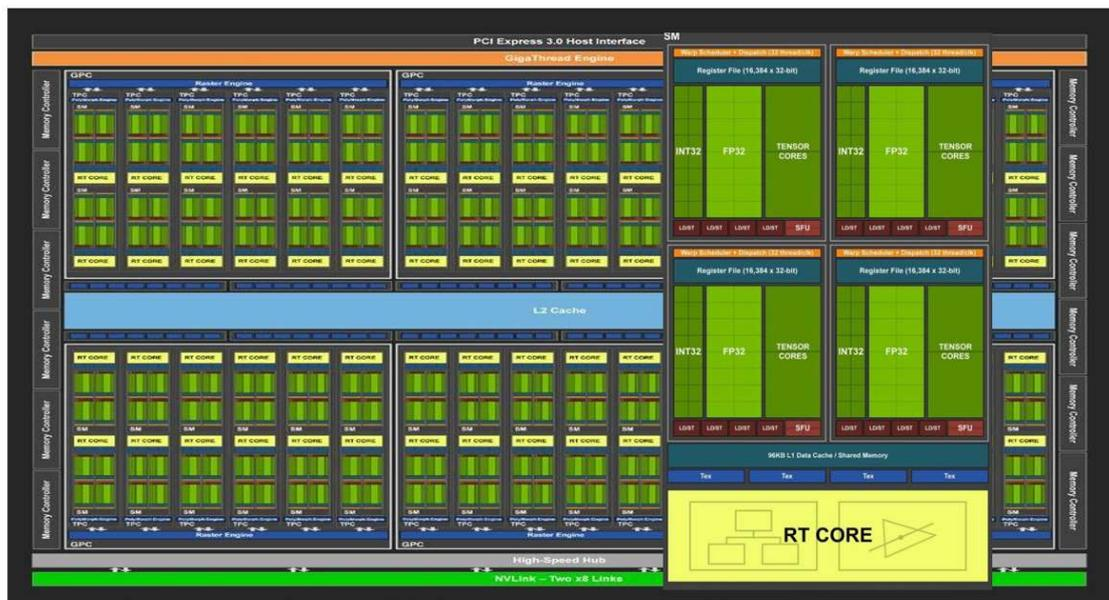
Figura 10. Arquitectura Turing TU102 con ampliación del SM. © Nvidia Corporation (modificado)
