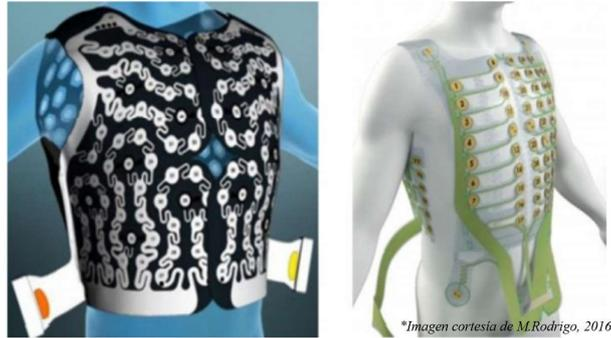
**Figura 5. Ejemplos de posicionamiento de electrodos para BSPM**
