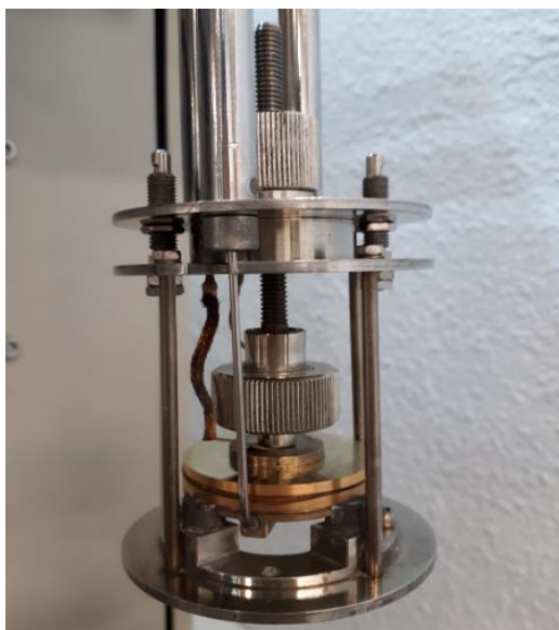
Figura 20. Imagen de la celda de medida con la muestra colocada entre los electrodos de cobre recubiertos con oro de 40 mm.
