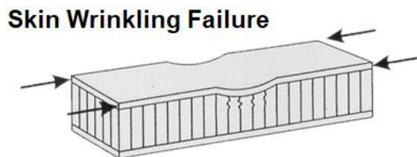
Figura 7. Modo de fallo wrinkling (Vitale et al., 2017).
