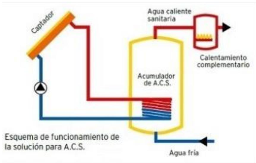
Ilustración 2: Sistema instalación ACS
