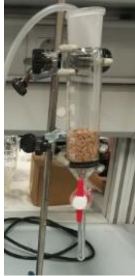
Figura 33. Detalle del filtro de arena del montaje experimental
