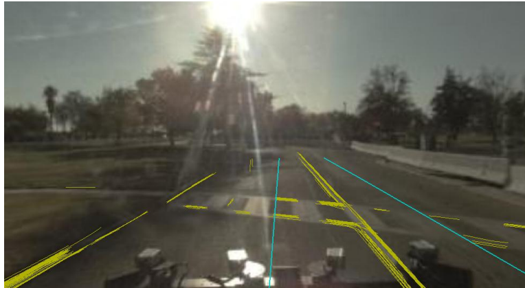
Figura 84. Para detectar el camino pintado y los bordes de la carretera el sistema utiliza varios sensores que aportan streams de datos asíncronos y heterogéneos (amarillo) y estimar la línea central de múltiples carriles (cian).
