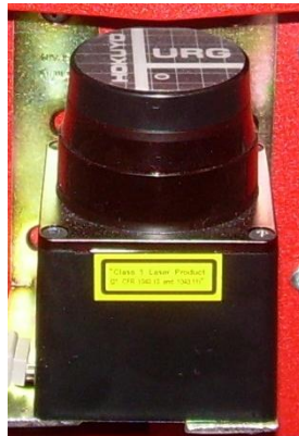
Figura 193. Láser de telemetría de la marca Hokuyo instalado en la parte frontal del robot Pioneer .
