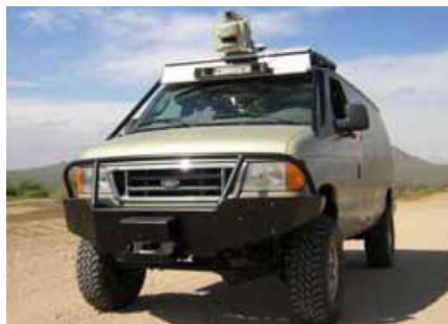
Figura 83. El vehículo utilizado en los experimentos es un modelo Ford E-350 Econoline, el cual lleva instalado un sistema LADAR para obtener los datos utilizados en la navegación.
