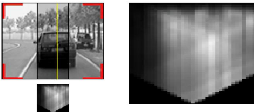
Figura 69. Detección de obstáculos mediante técnicas de simetría.
