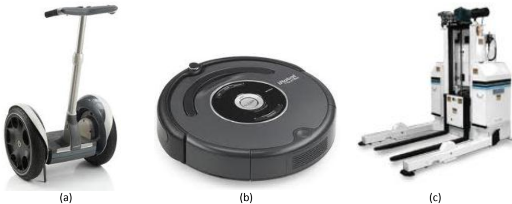
Figura 1. (a) Patinete automático Segway. (b) Robot escoba Roomba. (c) AGV industrial.
