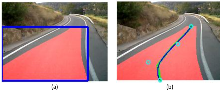
Figura 168. Ejemplo de carril de carretera: (a) imagen con el ROI (cuadro azul) y la región de interés resaltada en rojo, (b) resultado final con los puntos centrales (verde) y la estimación del camino con la RBC (azul).
