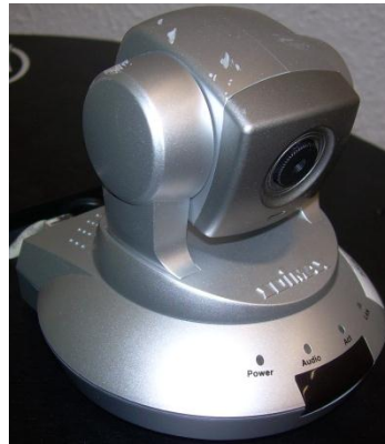
Figura 192. Cámara IP de la marca Edimax instalada en la parte superior del robot Pioneer .
