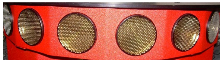
Figura 194. Anillo de sensores de tipo sónar que incorpora el robot Pioneer .
