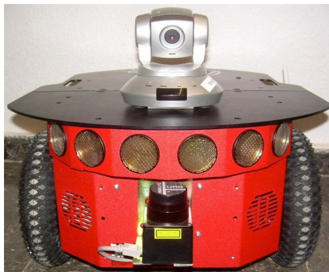
Figura 191. Robot Pioneer con diversos sensores: cámara, láser, sónar y encoders.
