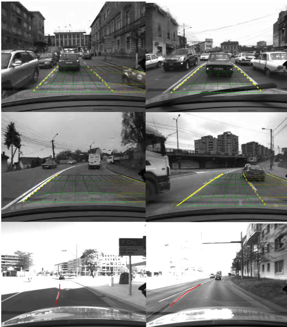
Figura 74. Ejemplos de detección de línea y modelado de carretera.
