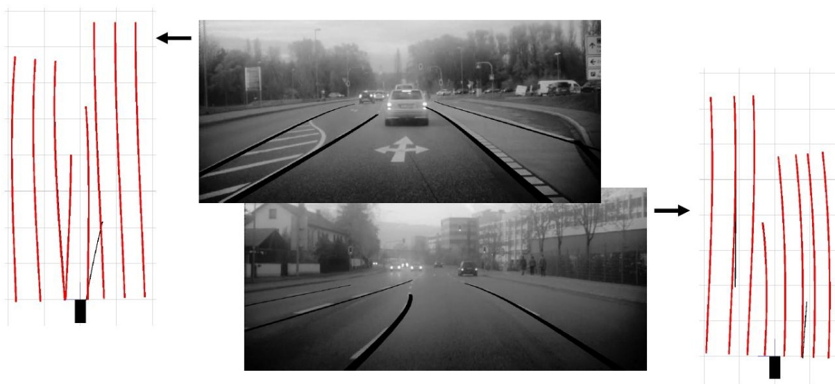
Figura 75. Detección de las líneas de los carriles de la carretera.
