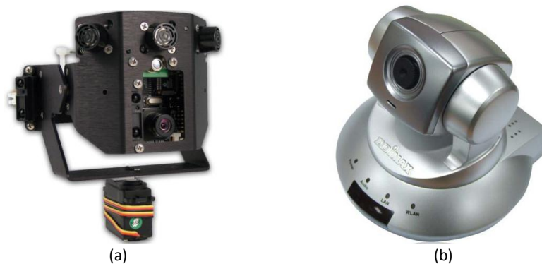
Figura 176. (a) Torre PTU para la CMUcam3. (b) Cámara IP con sistema PTZ.
