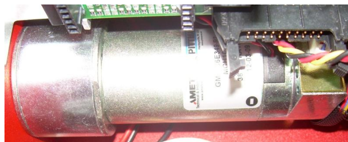
Figura 195. Motor y encoder de una de las ruedas del robot Pioneer .
