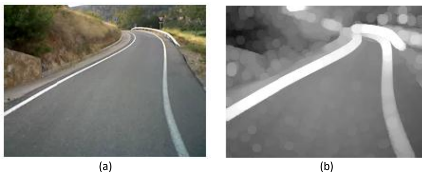
Figura 166. Ejemplo de carril de carretera: (a) imagen original y (b) imagen emborronada en escala de gris.
