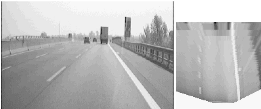
Figura 67. Reconocimiento de carretera mediante la técnica IPM para deshacer la perspectiva.
