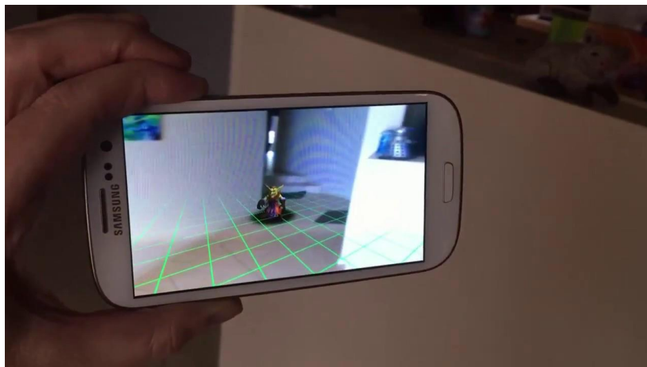
Figura 12: Demostración del uso de Artoolkit, como complemento de un sistema RASM, estabilizando la imagen.
