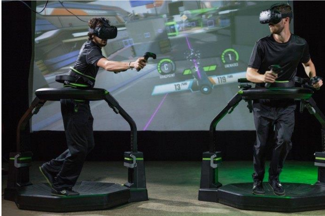
Figura 4: Virtuix Omni , plataforma diseñada para poder andar, correr y saltar mientras se usan gafas VR sin poner en peligro al usuario y su entorno.
