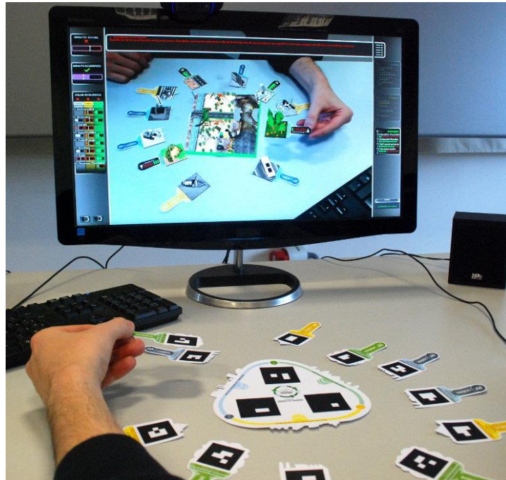
Figura 8: Estarteco, juego de Realidad Aumentada con marcas desarrollado por el Instituto Tecnológico de Castilla y León, sirve como ejemplo de aplicación RA con marcas.
