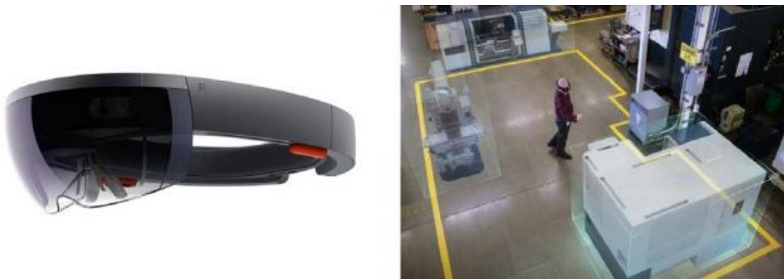
Figura 6: A la izquierda, las gafas Hololens de Microsoft; A la derecha, demostración de Microsoft Layout, en la que se colocan modelos digitales de maquinaria.
