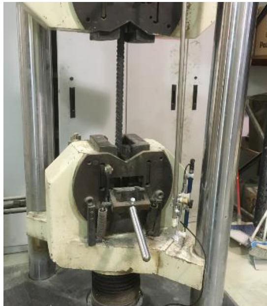
Figura 3.18: Dispositivo de pruebas en acero
