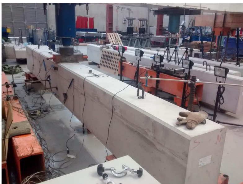
Figura 3.15: Instrumentación en viga previa a la puesta en carga
