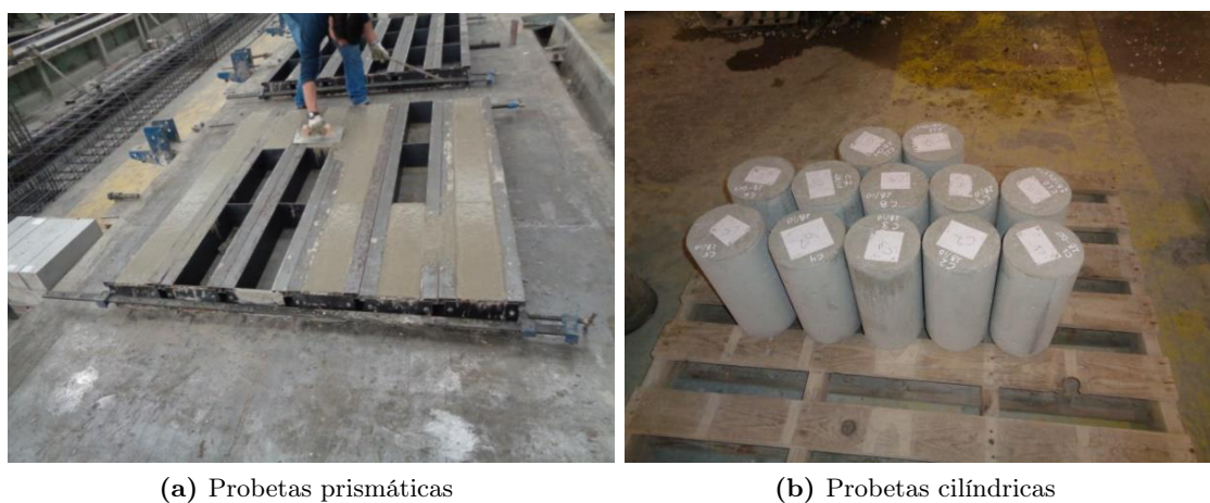
Figura 3.11: Proceso de fabricación de probetas de acompañamiento
