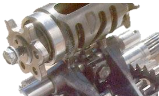
Figura 12. Tambor y horquillas de cambio
