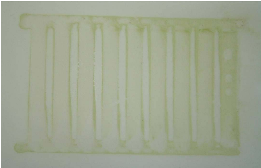
Membrana microfiltración (PVDF 0,2 \mu m) ensayada.
