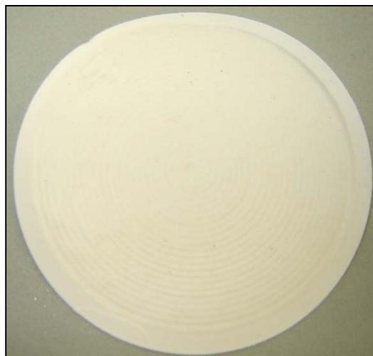
*Figura 4.8. Fotografía del filtro de 0,45  $\mu\text{m}$  utilizado en el ensayo SDI.*
