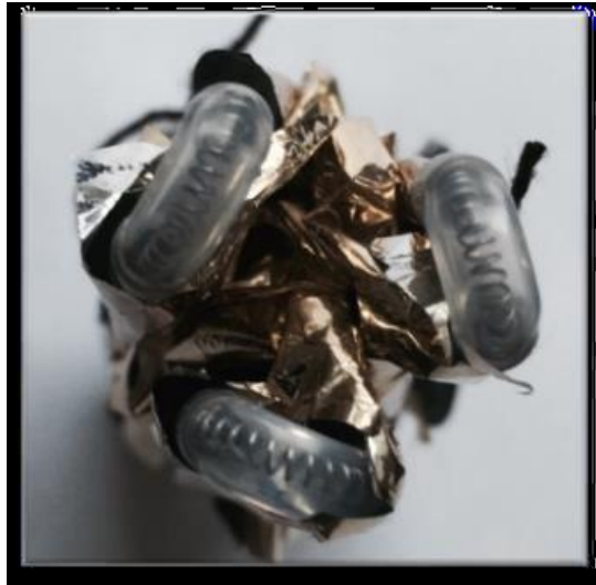
Ilustración 48: Detalle de muelles en las articulaciones (Fuente: [5])
