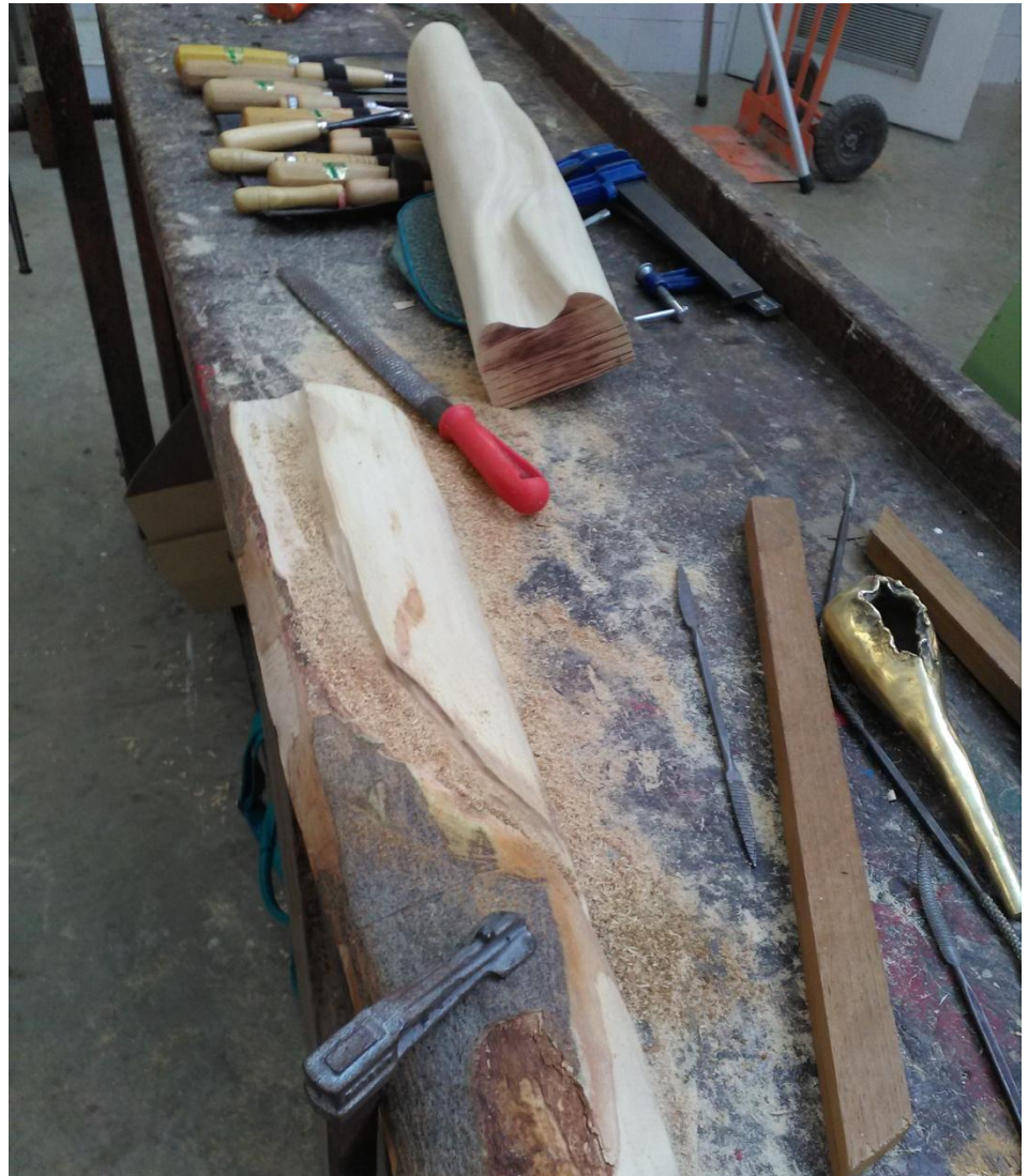
(fig.73). Fotografías del proceso. Talla de madera con gubias y lija de mano.
