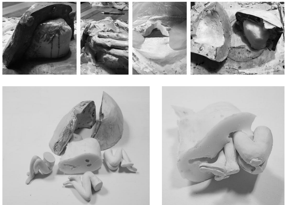
(fig.52). Fotografías del proceso. Molde de silicona y positivado de la pieza en escayola.
