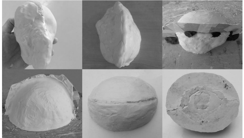
(fig.36). Fotografías del proceso. Creación del molde en silicona y camisa en escayola.
