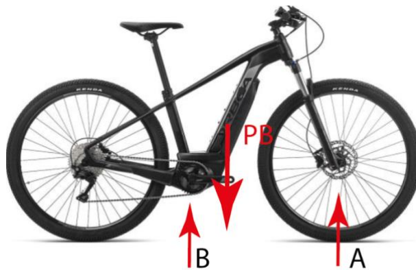
Ilustración 1. Reparto de fuerzas en la bicicleta. (www.orbea.com)
