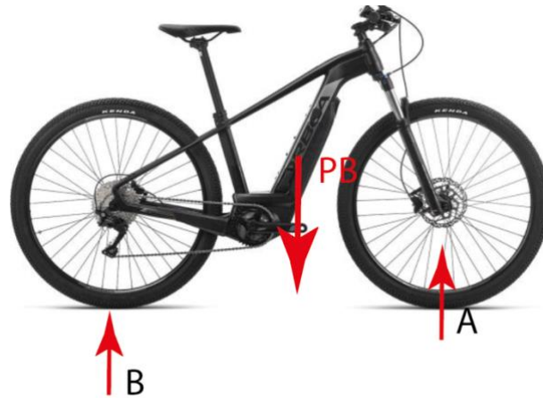
Ilustración 2. Reparto de fuerzas en la bicicleta cuando el banco esta replegado. (www.orbea.com)
