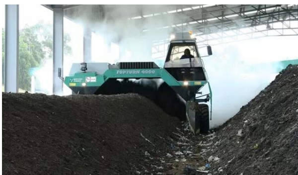
Il·lustració 11: Compostatge en piles de volteig en espai protegit de l'aigua i el sol
