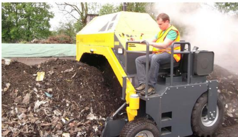
Il·lustració 28: Voltejadora Ecoalliance model IWK HR 2700
