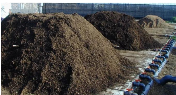
Il·lustració 10: Pila de compostatge estàtica amb ventilació forçada
