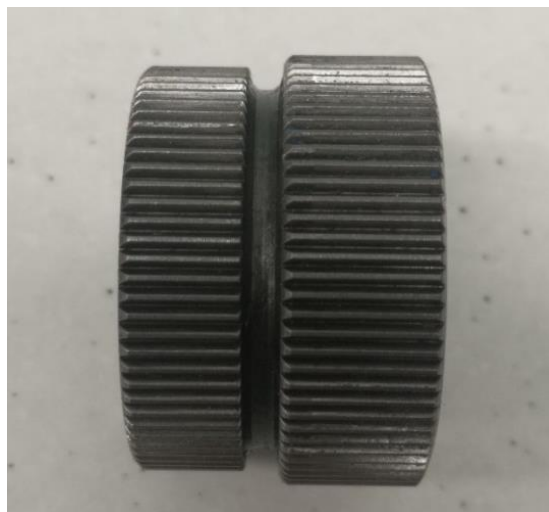
Figura 16. Geometría engranaje satélite ( Z_1 y Z_2 ).
