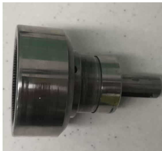
Figura 24. Prueba realizada en engranaje solar-árbol salida ( Z_4 ).
