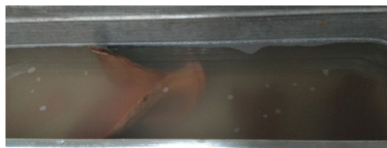
Fig. 25 Fotografía posterior a la inmersión de la pieza en ultrasonidos y tensoactivo.
