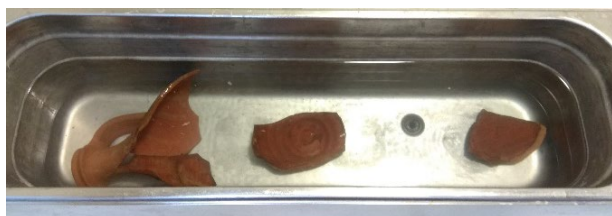
Fig. 24 Fotografía previa a la acción de la inmersión con ultrasonidos y tensoactivo.
