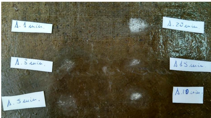
Fig. 18 Resultados de aplicación de Acetona con Nevek® sobre el lienzo de la Inmaculada.
