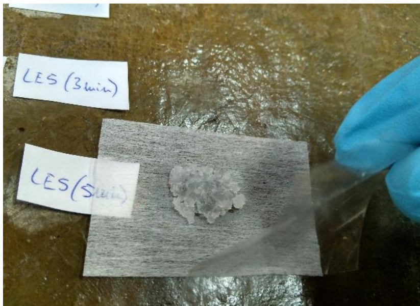
Fig. 15 Ejemplo de aplicación de la mezcla de disolvente con Nevek® sobre un Reemay®.
