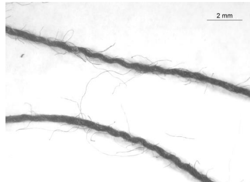
Fig. 37. En la parte superior: hilo de algodón y poliéster. En la parte inferior: hilo de algodón y poliéster. Tela mixta de trama abierta.
