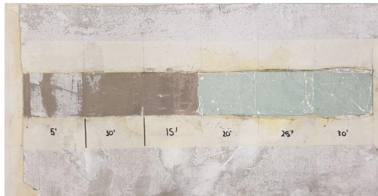
Fig. 49. Pruebas previas sobre el fragmento nº 4. Uso del decapante a diferentes tiempos de contacto.
