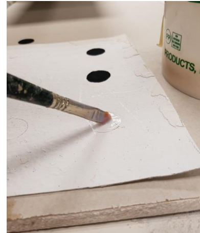
Fig. 44. Aplicación del Acril® 33 en la preparación de la probeta.
