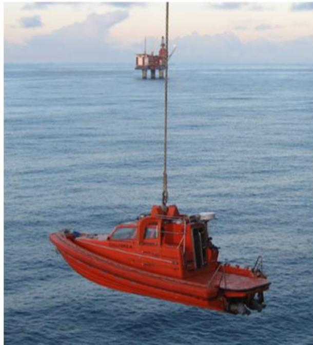
**Figura III.9. Fast Rescue Boat izado para prueba de funcionamiento**
