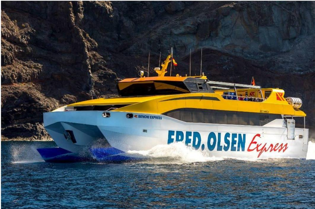
Figura III.39. Buque Benchi Express que navega en aguas Canarias fabricado en su totalidad con fibra de vidrio.
