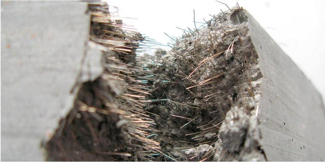
Figura III.32 Fibras metálicas en hormigón
