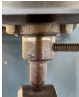
Figura 34. Penetrador de acero templado 1/16" de pulgadas de diámetro para el ensayo en la escala Rockwell B. (Fuente propia)
