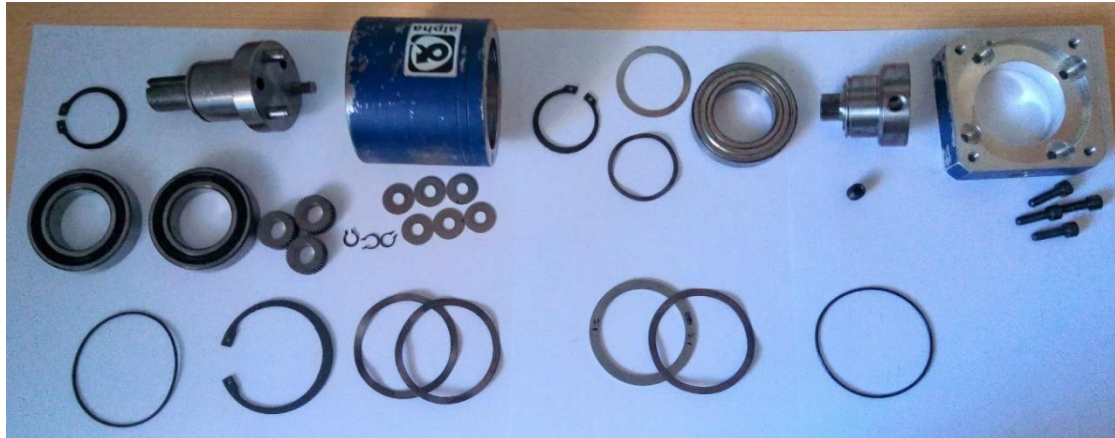
Figura 21. Despiece de toda la reductora. Se pueden apreciar todos los componentes principales de la máquina. (Fuente propia)
