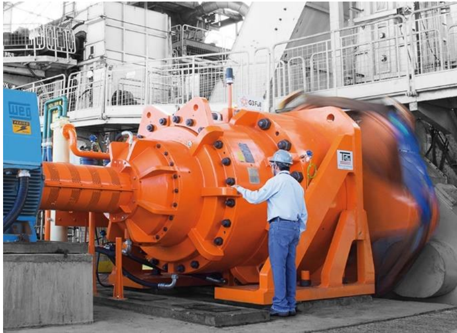
Figura 6. Reductora de engranajes planetarios empleada en el accionamiento de un molino industrial de azúcar. [4]
