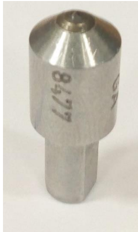
Figura 37. Penetrador de cono de diamante de 120° de ángulo de vértice empleado para la medición de las durezas de los engranajes en una escala Rockwell C. (Fuente propia)
