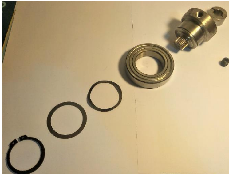
Figura 20. Despiece del árbol de entrada. (Fuente propia).
