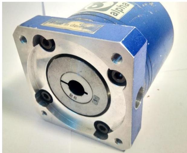
Figura 16. Fotografía del soporte-adaptador de la reductora LP 090-MO1-5-111-000 y su árbol de entrada con el casquillo montado en su interior. (Fuente propia).
