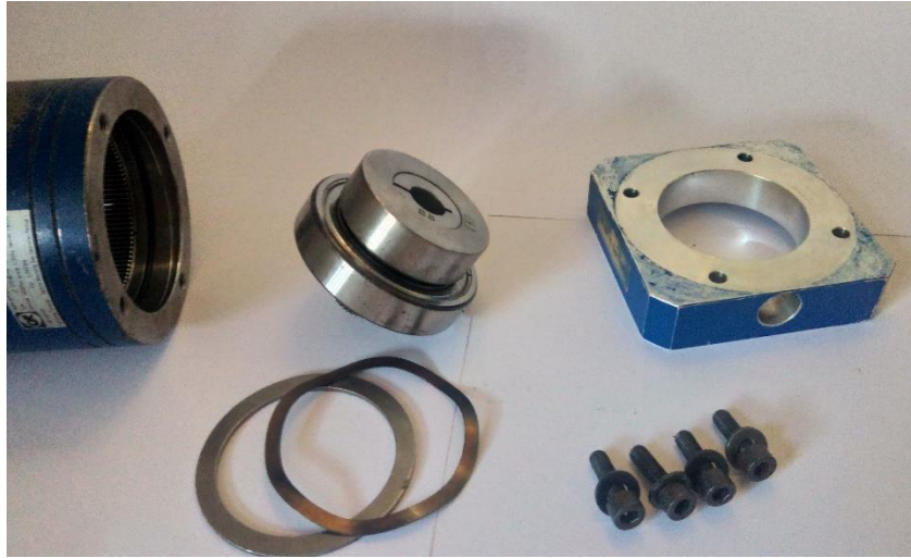
Figura 17. Despiece del árbol de entrada, soporte-adaptador y elementos auxiliares de sujeción y ajuste. (Fuente propia).
