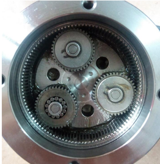
Figura 18. Interior del mecanismo de engranajes planetarios de la reductora. El engranaje inferior izquierdo puede apreciarse las agujas de rodamiento entre el engranaje satélite y el eje portasatélites. (Fuente propia).
