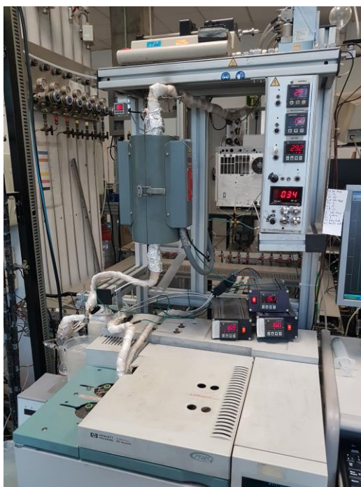
Figura 7. Fotografía del sistema de reacción empleado en la transformación en fase gaseosa de glicerol.
