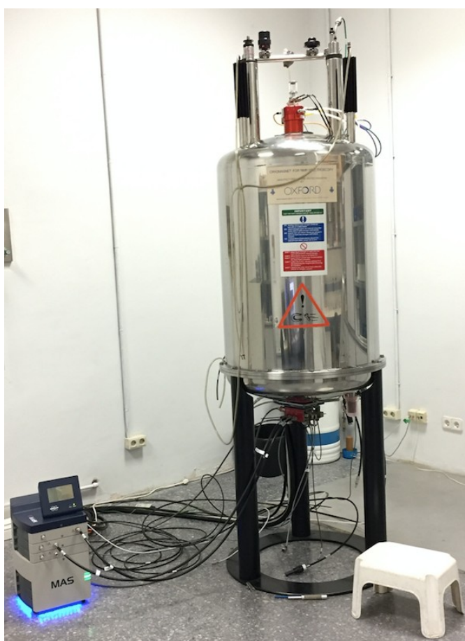
Figura 15. Equipo de RMN de sólidos empleado.
