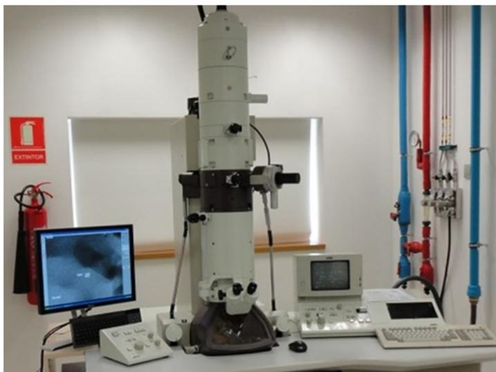
Figura 9. Microscopio Electrónico de Transmisión Philips 100kV disponible en el Servicio de Microscopía de la UPV.
