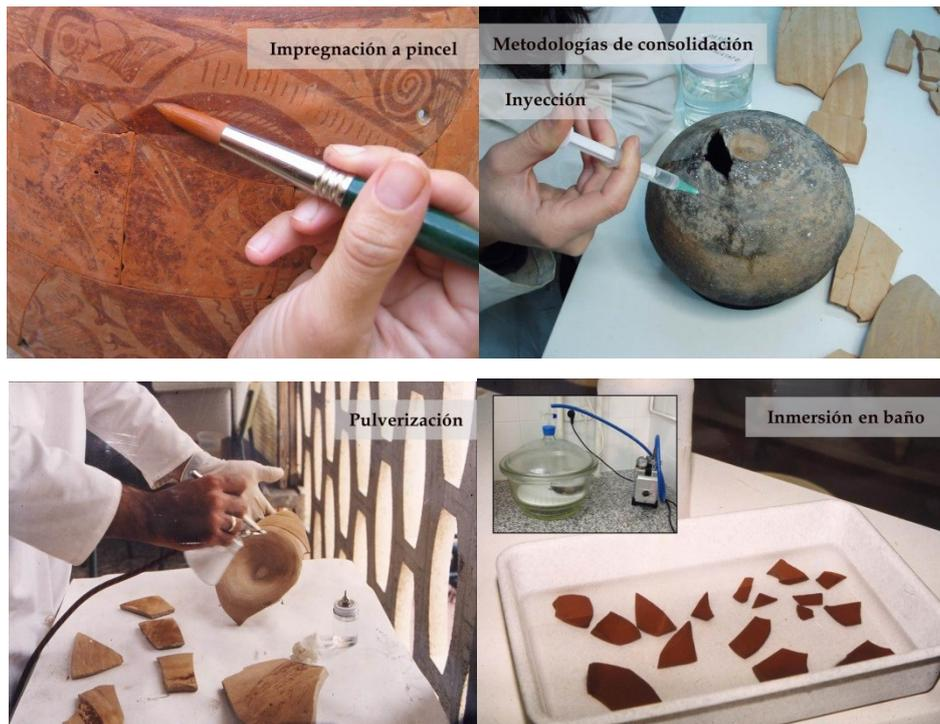
Figura 2. Técnicas para aplicar el consolidante a la pieza arqueológica
