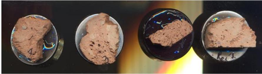
Figura 34. Piezas sin tratar y tratadas preparadas para el ensayo de colorimetría. (1) tratada en Nano Estel, (2) sin tratar, (3) Nano Estel 1:1, (4) Nano Estel 1:3
