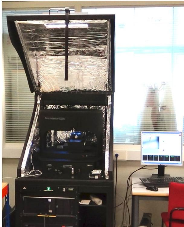
Figura 11. Nanoindentador G-200 del Instituto de Tecnología de Materiales, utilizado para determinar la dureza y módulo superficial de las piezas arqueológicas.
