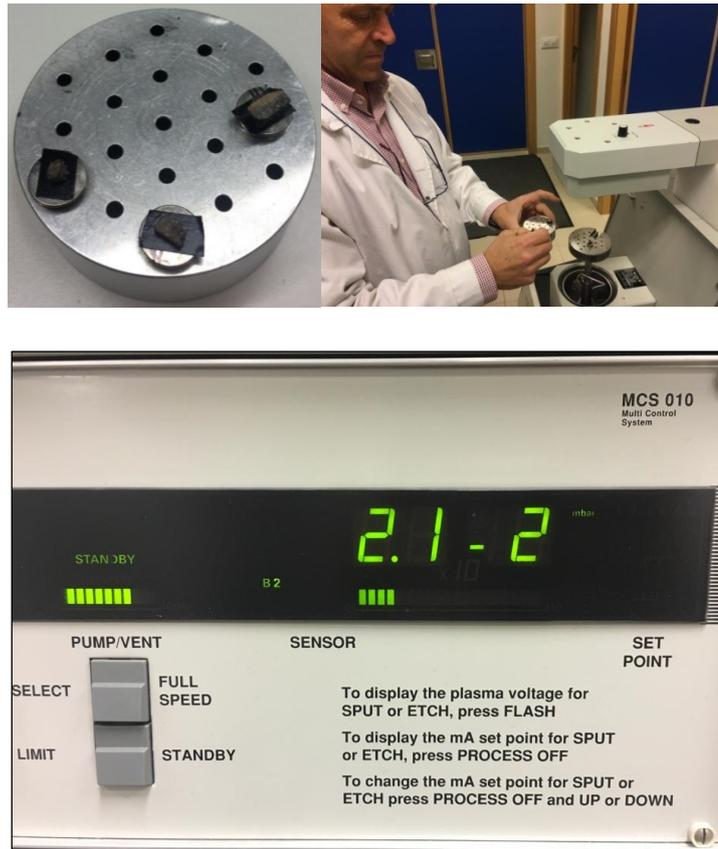
Figura 8. Fotografía de las muestras colocadas en el porta del FESEM pasando a la etapa de metalizado mediante glow discharge.
