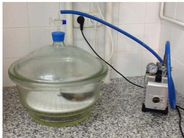
Figura 16. Sistema de campana para hacer vacío y mejorar así la penetración del consolidante en el material tratado.
