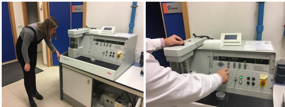
Figura 7. La autora esperando a que el metalizador de platino por Sputtering alcance el nivel de vacío necesario para iniciar la deposición en frío de la película de platino.
