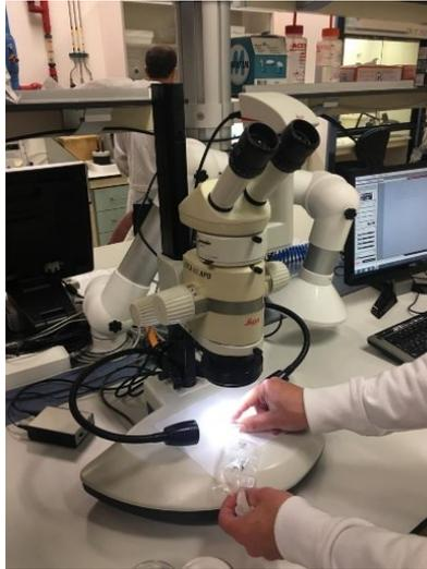
Figura 5. Lupa estereoscópica utilizada para observar la superficie de las muestras. Leica MZ APO
