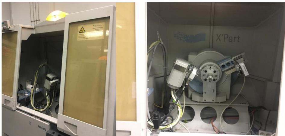
Figura 10. Equipo de DRX con control de temperatura del Instituto de Tecnología Química (ITQ-UPV), utilizado para analizar la composición y grado de cocción de las piezas cerámicas y arcillosas.
