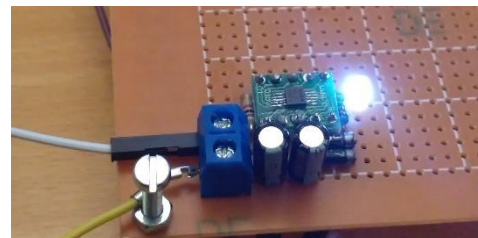
Figura 4. Cargador de litio para dos baterías en serie basado en la familia MCP de Microchip.
