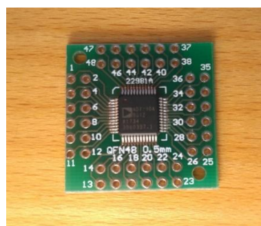
Figura 38. Adaptador y microchip soldados
