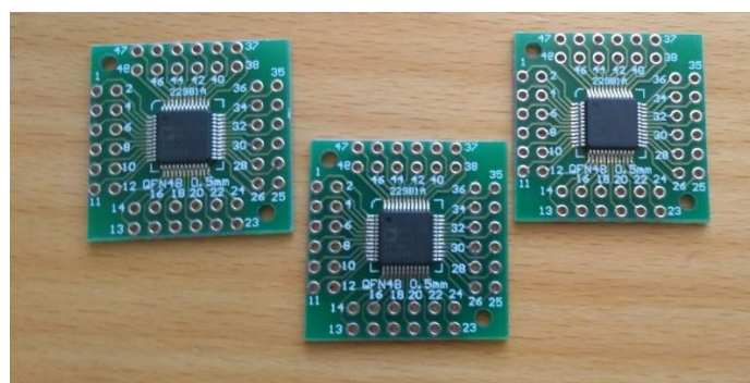
Figura 39. Los tres procesadores soldados a sus adaptadores
