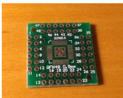
Figura 37. Adaptador de LQFP48 a pin estándar
