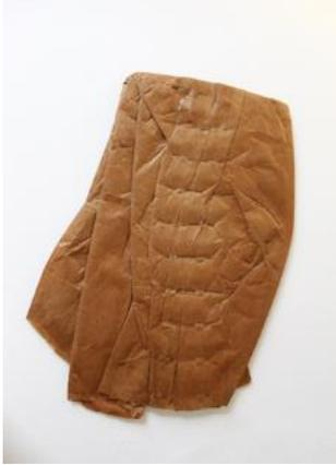
fig.24 Prueba de cartón con pliegues impermeabilizado.
