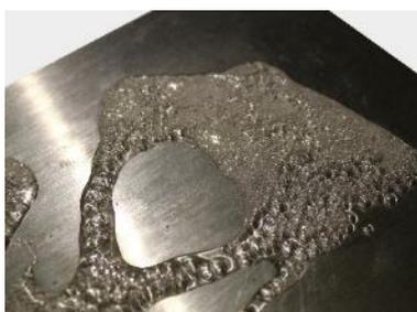
fig.22 Prueba de Paraloid B-72 sobre plancha de zinc, 14 x 8,0 cm.
