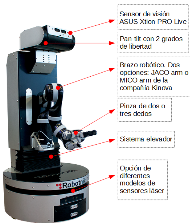
Ilustración 5: Elementos principales del RB-1
