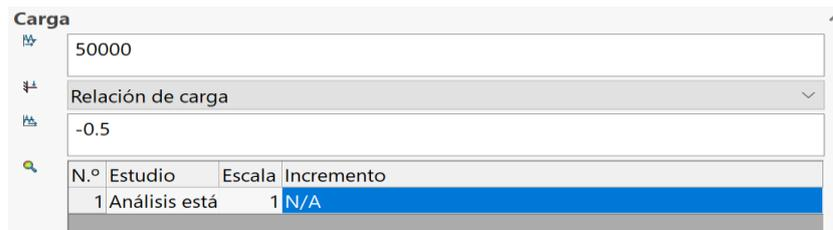
Figura VI-14. Establecimiento de suceso de carga en Solidworks para cumplimentar con la normativa en el ensayo de fatiga.
