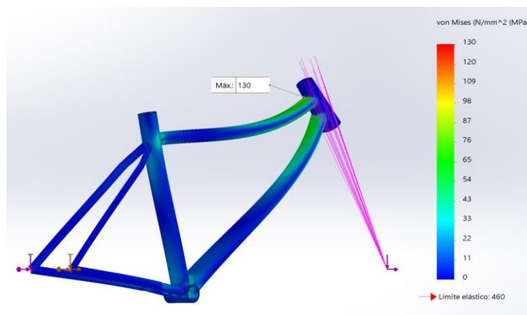
Figura VI-20. Ensayo con fuerzas horizontales. Tensión de Von Mises.
