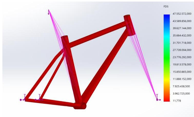
Figura VI-40. Ensayo con fuerzas verticales. Factor de seguridad.
