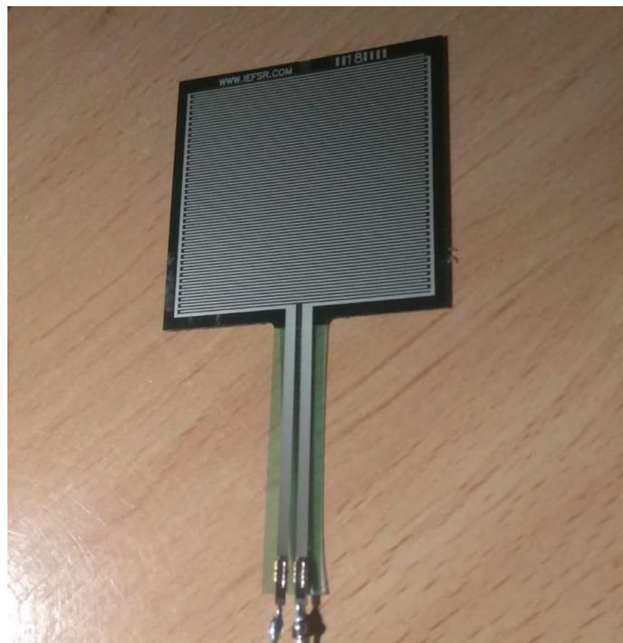
Ilustración 5 Sensor FSR
