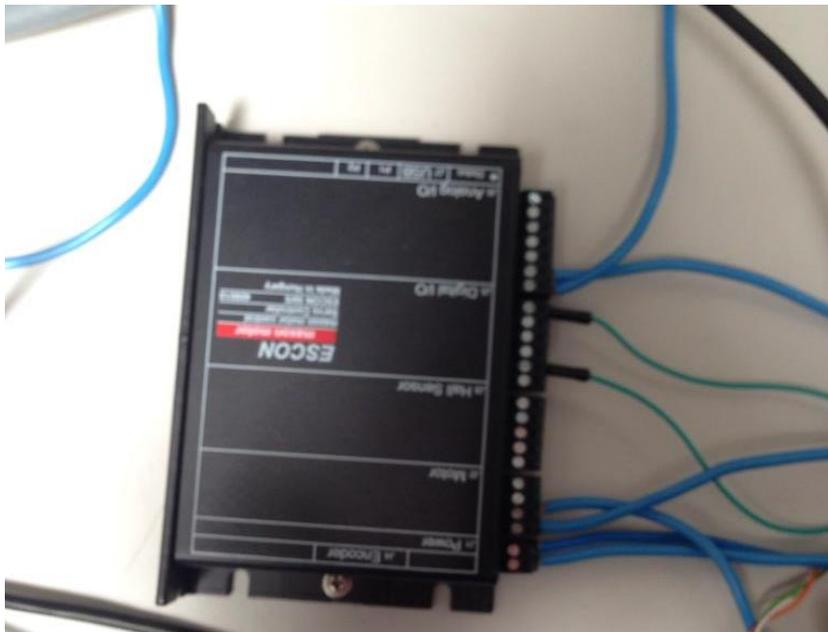
Figura 31: Controlador Escon y conexiones
