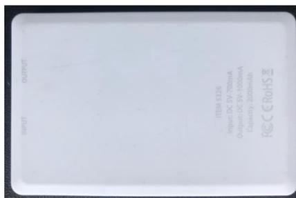
Figura 35. Batería de alimentación de la placa principal (*PowerBank*).
