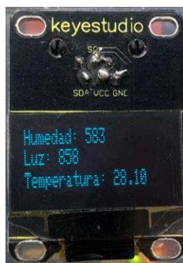
Figura 95. Resultado instrucciones de inicio y configuración de la pantalla OLED.
