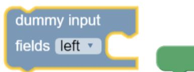
Figura 49. Bloque de configuración “Dummy Input” y resultado de este.
