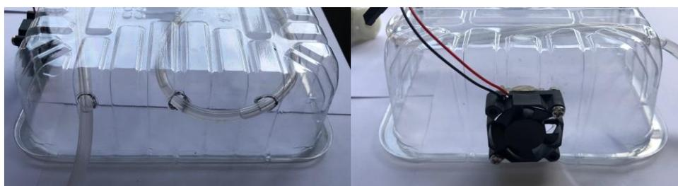
*Figura 112. Resultado final de la colocación del conducto y del ventilador en la cubierta superior.*
