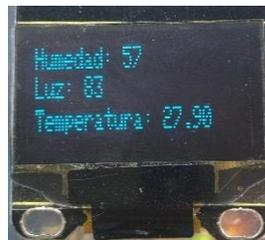
Figura 97. Resultado instrucciones de inicio y configuración de la pantalla OLED con reescalado.
