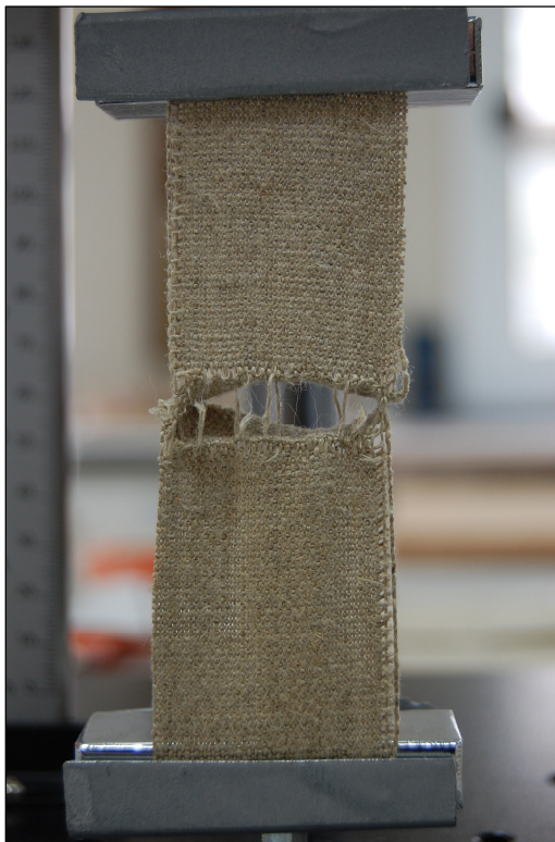
Fig. 33. Detalle de rotura en la costura de “punto de sábana”
