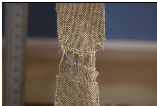
Fig. 34. Detalle de rotura en la costura de “punto por encima”
