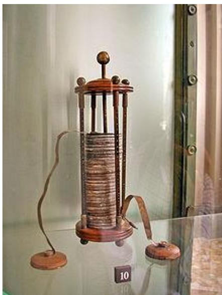
*Ilustración 13 Pila de Volta*
