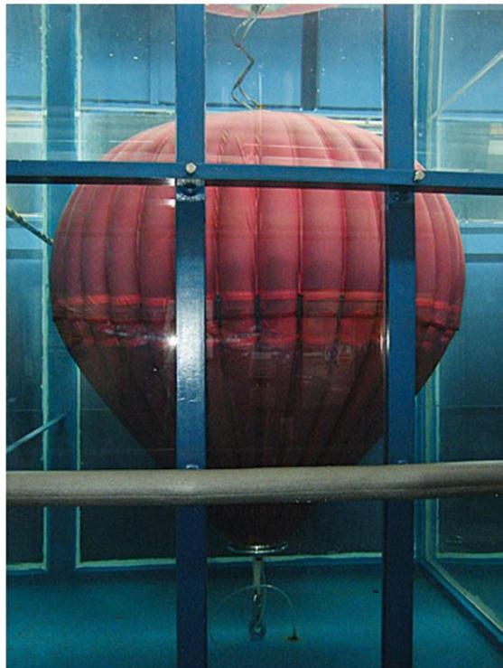
*Ilustración 38 Recipiente flexible de diámetro 1.8 m diseñado en la Universidad de Nottingham (2011)*
