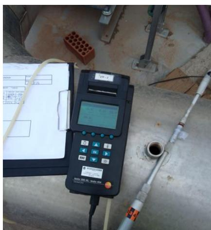
*Figura 5.5 Determinación del velocidad, presión y temperatura en el conducto exterior a la entrada del ventilador. Fuente: elaboración propia.*
