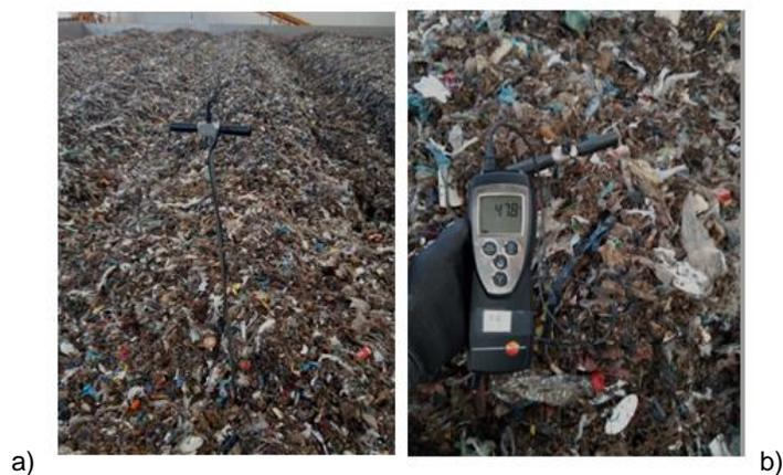
Figura 5.2 a: punto de toma de temperatura sonda térmica HANNA. b: sonda térmica HANNA a.
