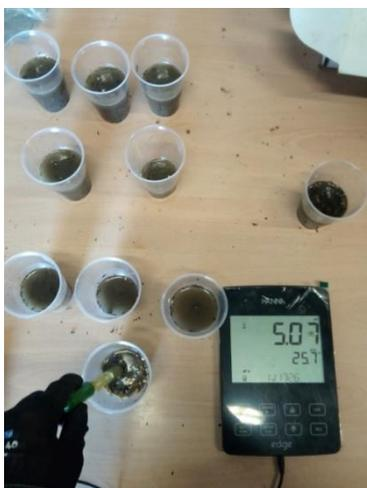
*Figura 5.4 Determinación del pH. Fuente: elaboración propia.*
