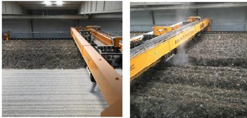
a) *Figura 3.5 a: reactor fermentación en la semana 2 (más de un cuarto de reactor cargado) b: reactor fermentación en la semana 4 (carga completa del reactor) Fuente: elaboración propia.*
