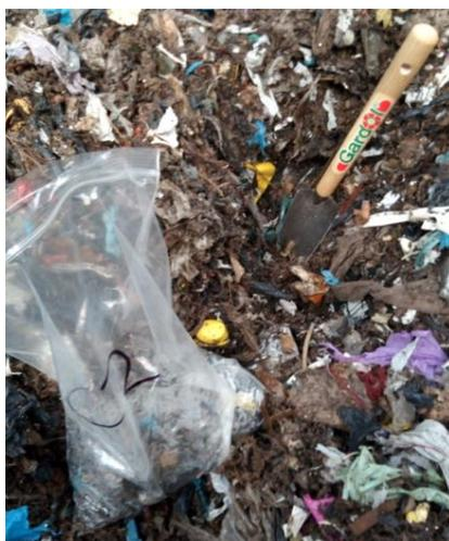
Figura 5.3 Recogida muestra para la determinación de humedad y pH (punto C2).
