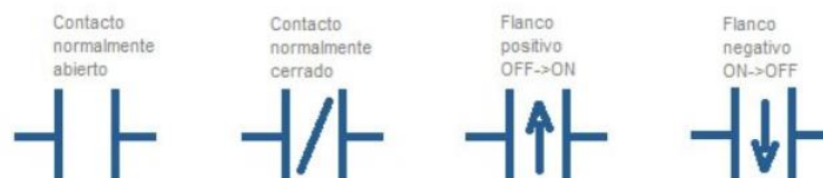
Ilustración 33. Tipos de contactos en lenguaje ladder
