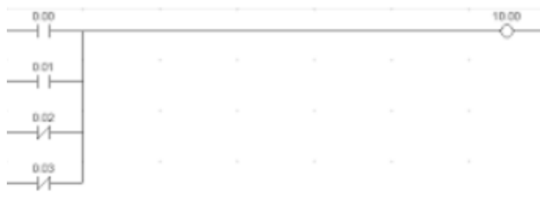
Ilustración 35. Ejemplo contactos en combinación “OR”
