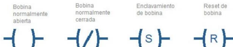
Ilustración 36. Tipos de bobinas en lenguaje ladder
