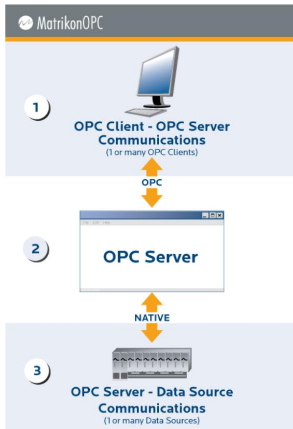
Ilustración 50. Explicación funcionamiento OPC por Matrikon
