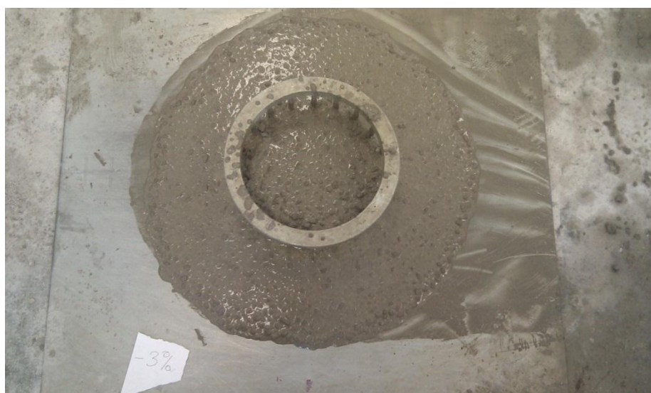
Ensayo de Escurrimiento del anillo Japonés
