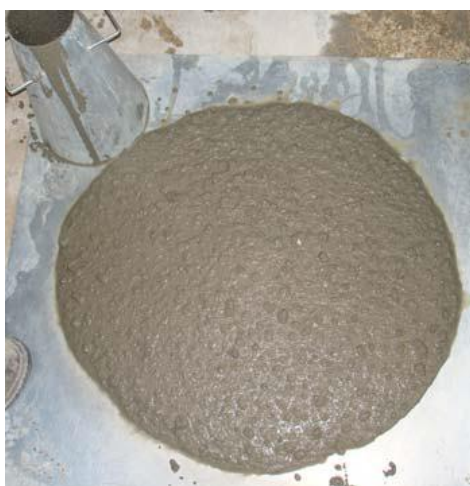
Figura 2.10. Resultado final del ensayo de escurrimiento.
