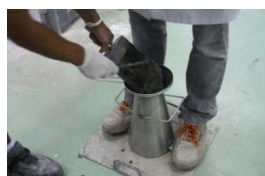
a) Introducción de masa en tres fracciones.
