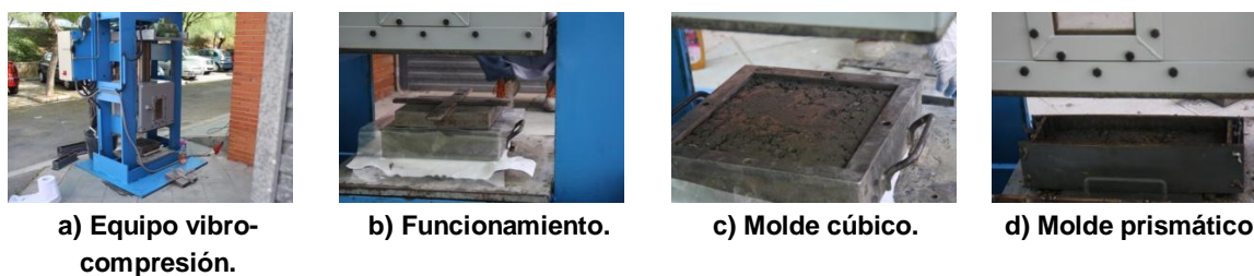
Figura 13. Procedimiento ensayo vibrocompresión.
