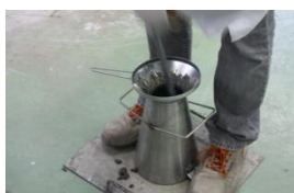
b) Picado de la masa (25 golpes) introducida.
