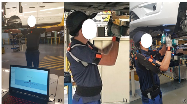
Fig. 3. a) Calibración del sujeto; b) atornillado sin exoesqueleto; c) atornillado con exoesqueleto (Fuente propia)
