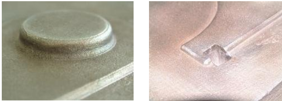
Figura IV-34. Piezas ya sinterizadas en diferentes posiciones (detalles del acabado superficial)
