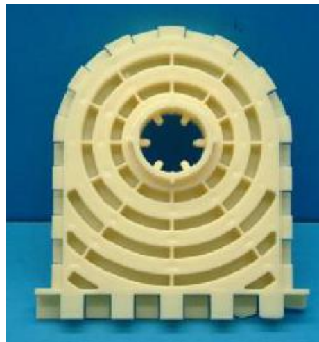
Figura IV-50. Pieza inyectada en ABS
