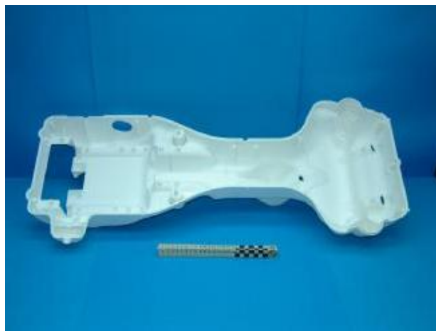
Figura III-34. Piezas fabricadas en poliamidas unidas
