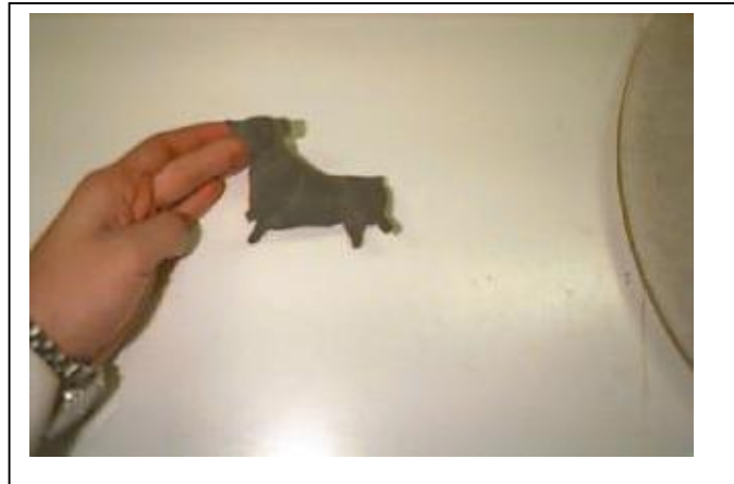
Figura IV-10. Pieza de sinterizado metálico defectuosa
