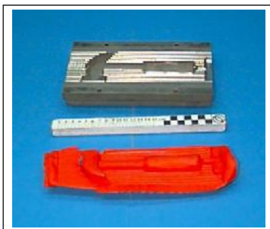
Figura IV-15. Molde para soplado y pieza obtenida: martillo
