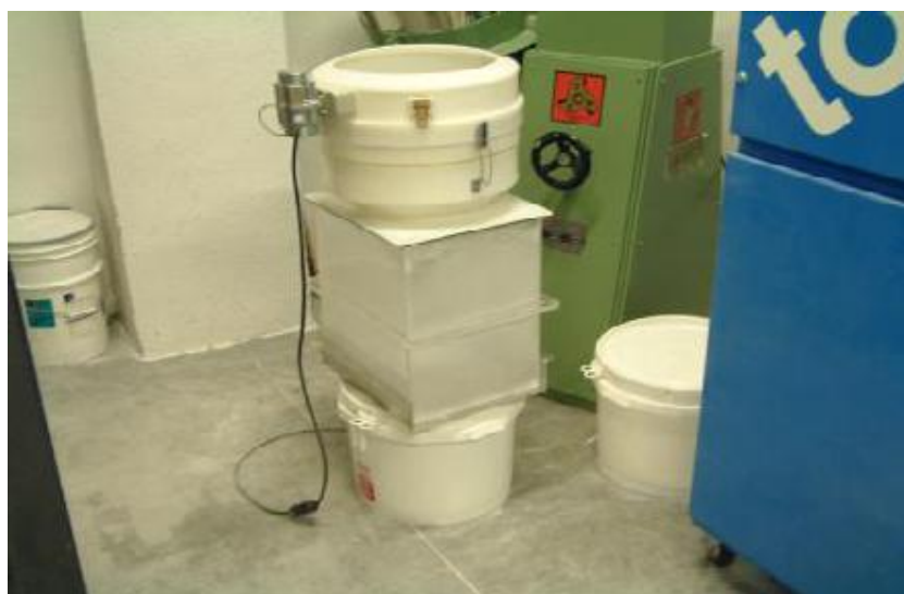
Figura III-49. Tamizadora y cartuchos con material
