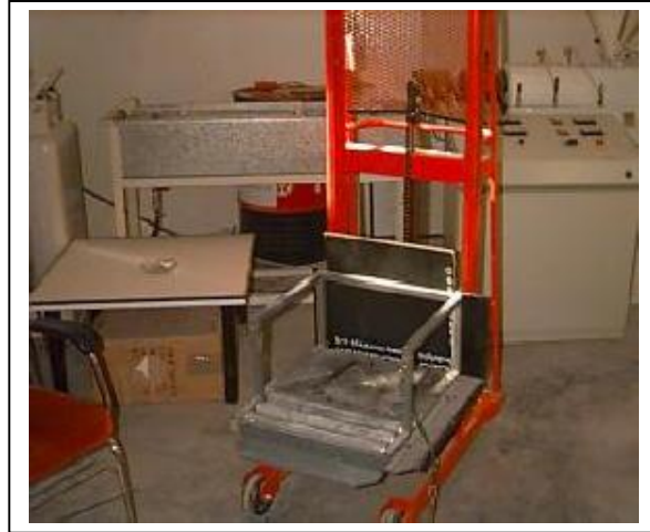
Figura III-30. Unidad hidráulica de transporte de materiales
