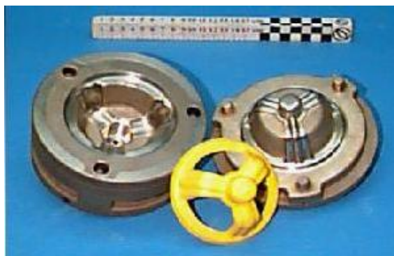
Figura IV-31. Molde y pieza inyectada en plástico
