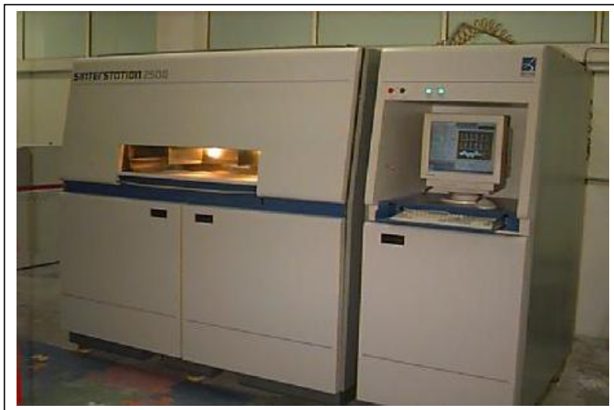
Figura III-17. Máquina de sinterizado selectivo por láser.
