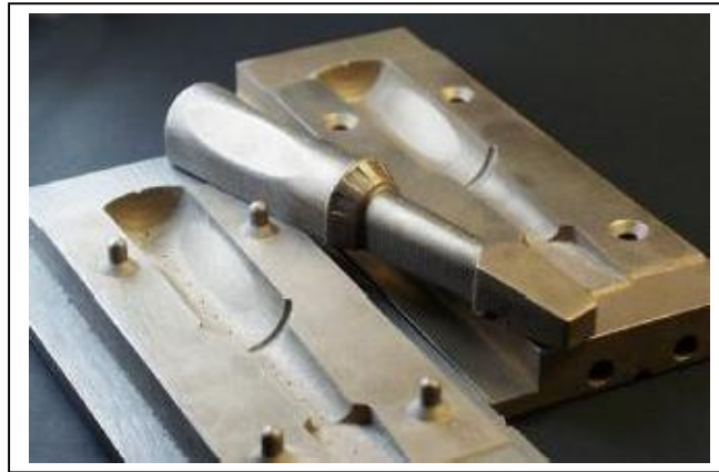
Figura III-18. Molde obtenido por SLS en Rapidsteel.
