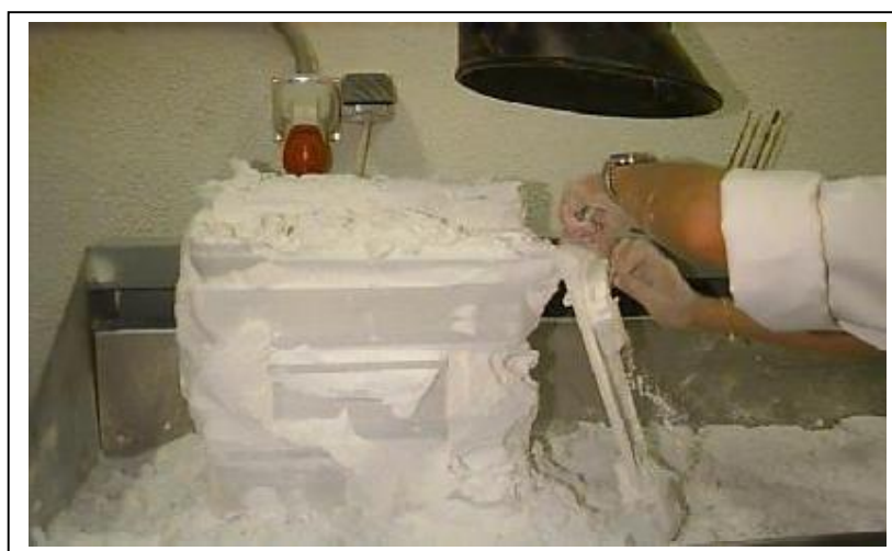
Figura III-29. Bloque de polvo y piezas sinterizadas
