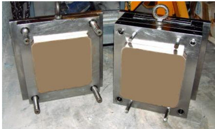
Figura IV-41. Portamoldes de dimensiones 160x160mm.
