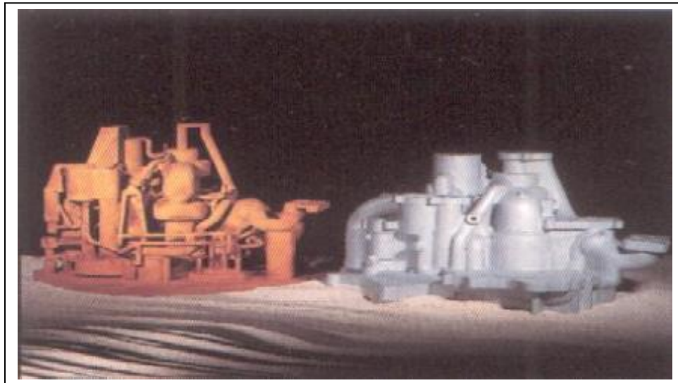
Figura III-37. Piezas sinterizadas en Sandform
