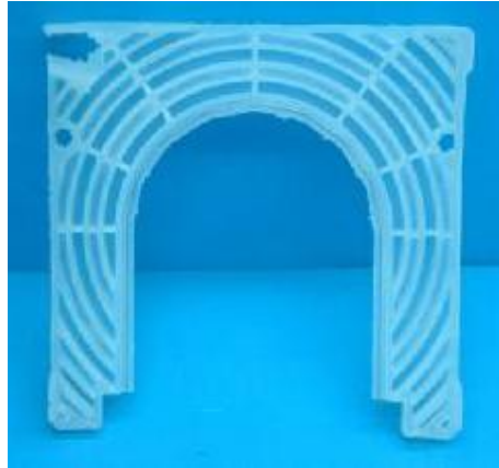
Figuras IV-48 y IV-49. Piezas inyectadas en EVA y ABS respectivamente
