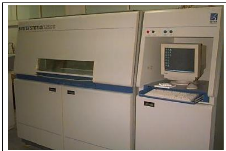
Figura III-23. Máquina de SLS DTM-2500 en AIJU
