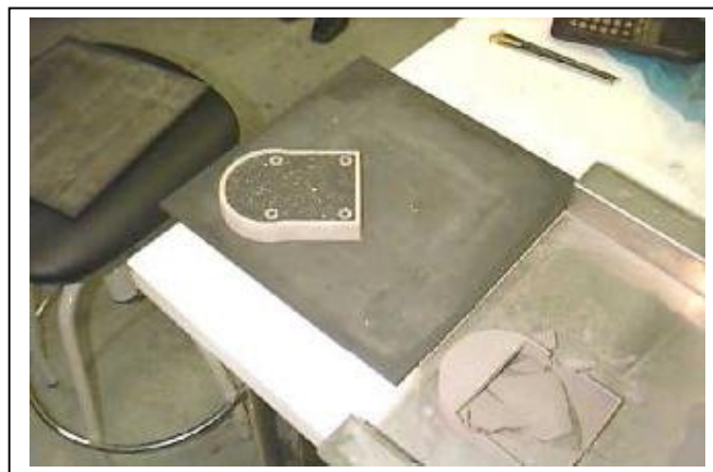
Figura IV-9. Pieza en verde con alúmina y pieza rota
