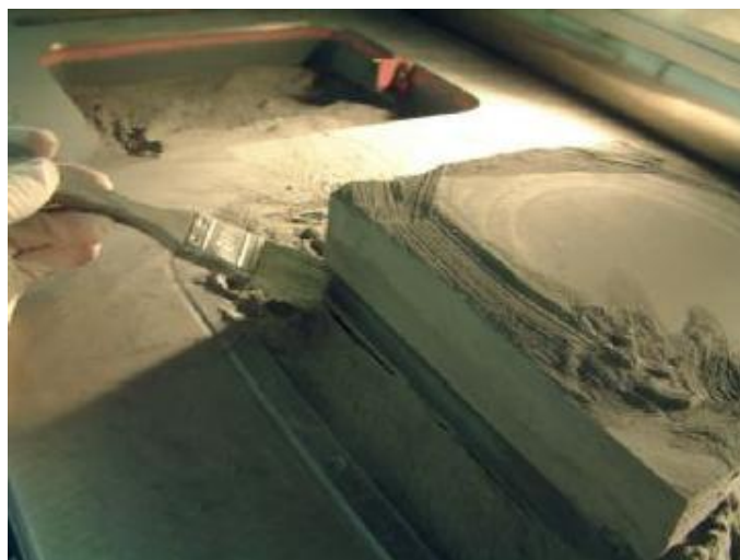
Figura III-50. Piezas ya sinterizadas en la Cámara de Proceso
