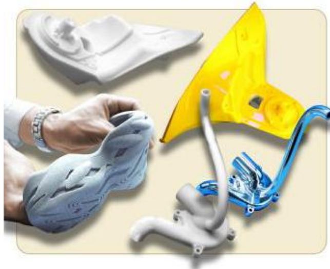
Figura IV-6. Ejemplos de piezas sinterizadas y tratadas posteriormente.
