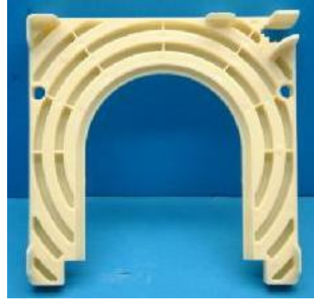
Figuras IV-48 y IV-49. Piezas inyectadas en EVA y ABS respectivamente
