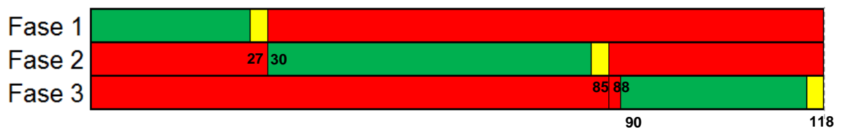
Figura 8. Diagrama de fases de la intersección semaforizada Av. del Bombero - Av. Leopoldo Carrera
