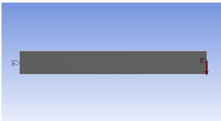
Figura 13: Condiciones de contorno para el problema en ANSYS Workbench. La etiqueta A señala la cara fija, y la B la cara con la fuerza vertical.
