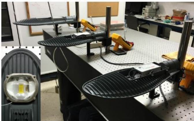
Figura 2.26: Sistema real experimental de la luminaria HP-LED.
