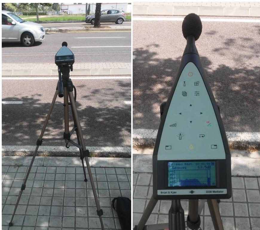
**Figura 7. Imagen izquierda: equipo de medición completo. Imagen derecha: sonómetro y micrófono realizando la medición *in-situ*. Elaboración propia.**
