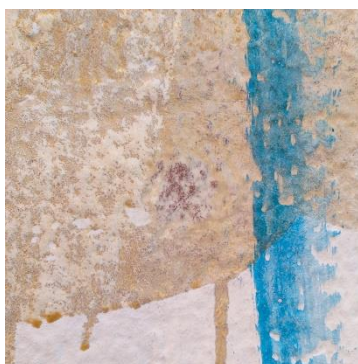
Fig.72. Detalle del momento en el que la primera capa de pintura blanca se deshizo con el agua
